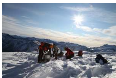
Landesgeologen beim Permafrost-Monitoring: Eisbohrung mittels Dampfbohrmaschine am Hintergrat des Ortlermassivs.
